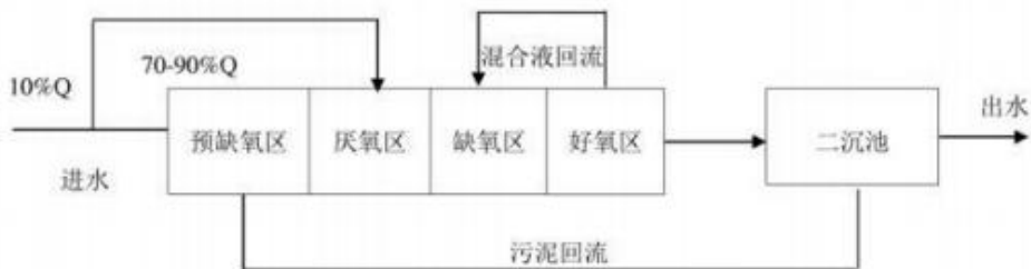
图 5-1 改良 A 2 /O 工艺流程图
