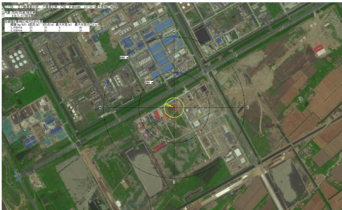
图 6.7.3-5 正己烷储罐泄漏最不利条件下危害示意图
