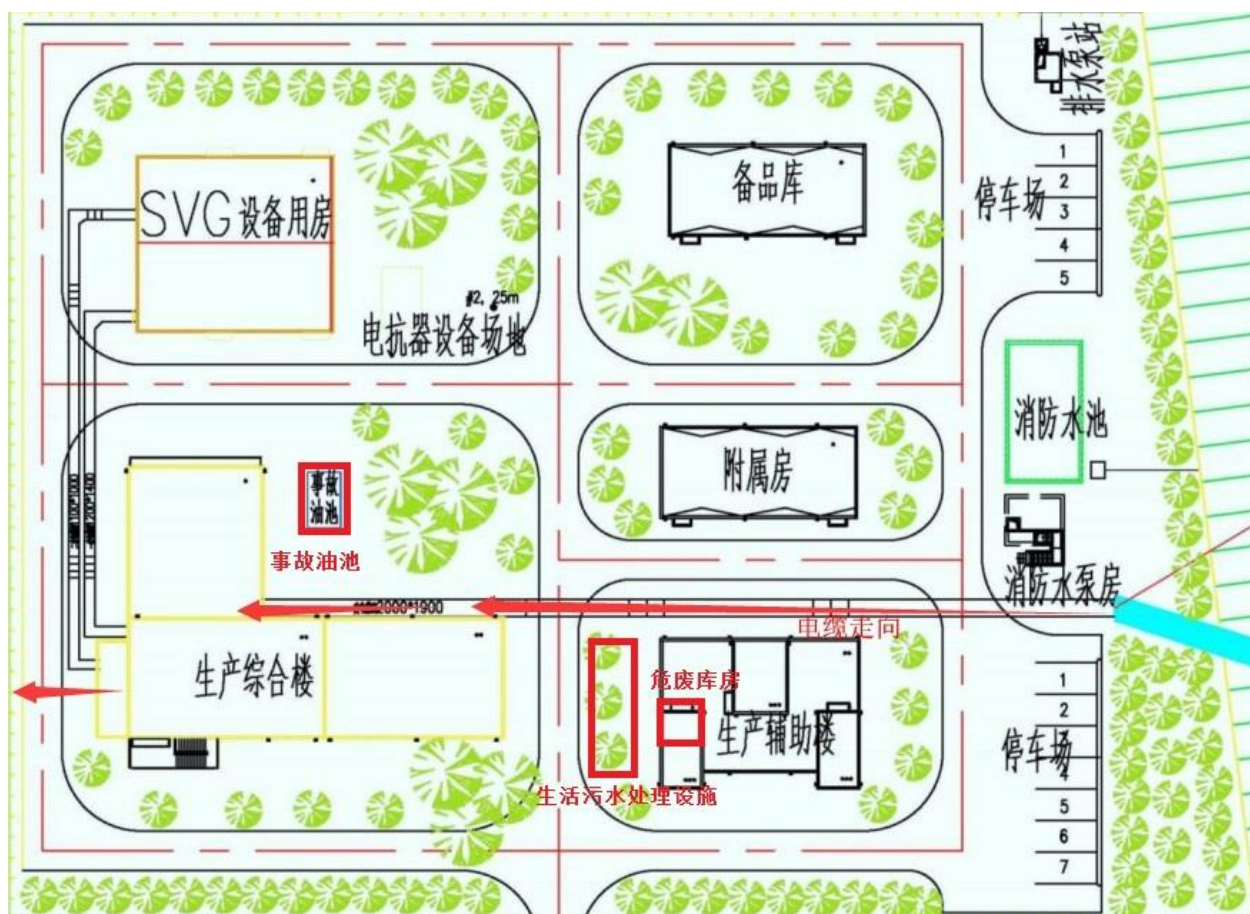
图 4-3 集控中心平面布置及场内输电线路路径图
