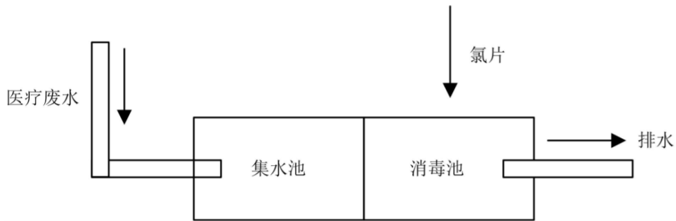
图 3-1 小型污水处理设施工艺流程图
